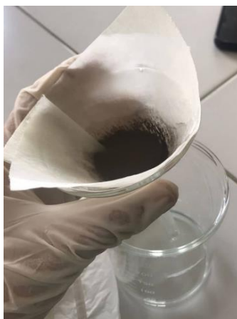
Proses Pemisahan Adsorben dan Sampel dengan Penyaringan
