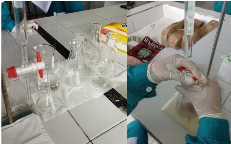
Peralatan Titrasi dan Proses Titrasi Kompleksometri
