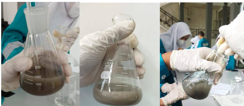
Proses Adsorpsi Berlangsung dalam Campuran Sampel dan Adsorben
