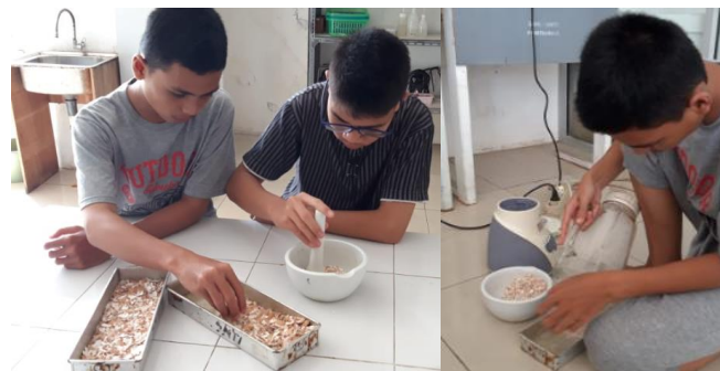
Gambar 4.1c. Pengecilan Ukuran Partikel Cangkang Telur
